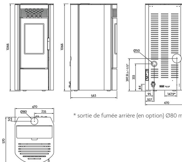
\* sortie de fumée arrière (en option) Ø80 mm.
