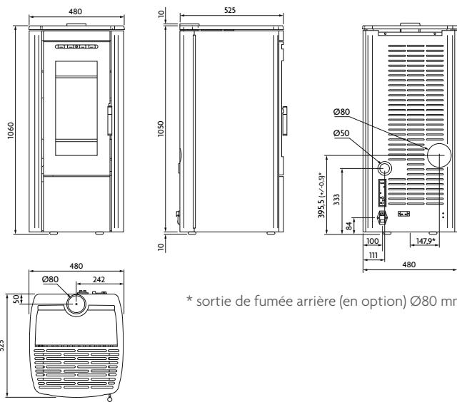
\* sortie de fumée arrière (en option) Ø80 mm
